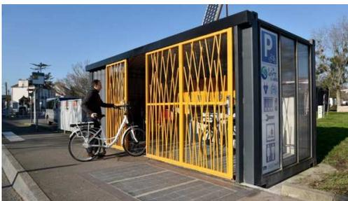
REZÉ, FRANCE. EN ZONE URBAINE, L'ÉNERGIE PRODUITE PAR LES 3 M<sup>2</sup> DE REVÊTEMENT PHOTOVOLTAÏQUE WATTWAY PERMET DE RENDRE AUTONOME UN ABRI-VÉLO SÉCURISÉ ET ASSURE LA RECHARGE DES VÉLOS ÉLECTRIQUES.
